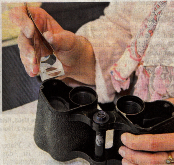
Die Ferngläser werden in sämtliche Einzelteile zerlegt, gereinigt und zusammengesetzt.
