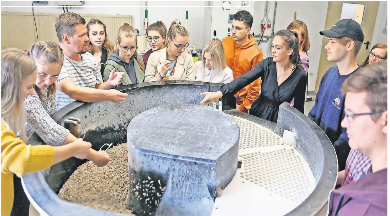
In der Mom GmbH hat Chef Mathias Schröder (3. von links) u. a. die Maschine gezeigt, mit der die frisch ausgeschnittenen Titanbrillenfassungen entgratet werden.
