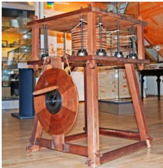
Ein Nachbau der Vielschleifmaschine, mit der gleichzeitig elf Linsen geschliffen werden konnten. FOTOS (2): OIMR
